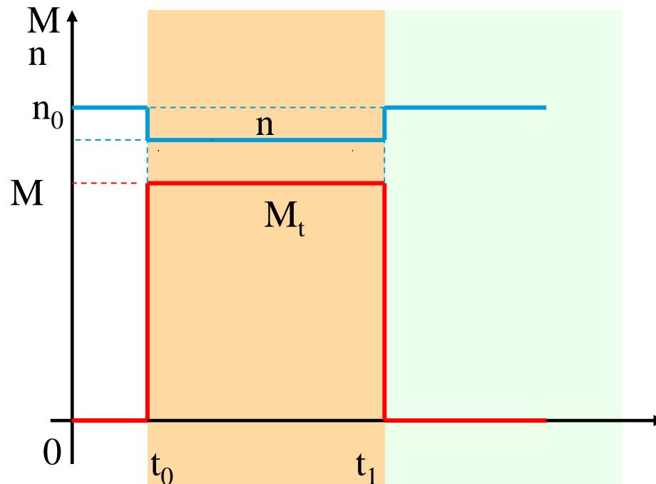
Udarno opterećenje i rasterećenje na osovini motora nakon praznog hoda,
