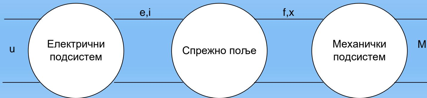
**Električni i mehanički podsistemi posebno sadrže svoje elemente u kojima se gubi energija, dok se u sprežnom polju gomila energije a proces pretvaranja odvija se bez gubitaka.**
