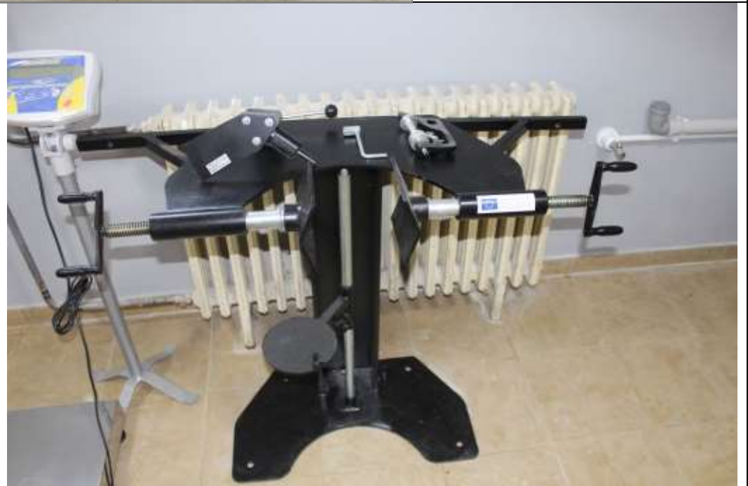
Ручна стега са завојним вретенима и изменљивим пакновима и уграђеним држачем боца за демонтажу (одвијање) и монтажу (завијање) вентила апарата CO_2 од 1,5-50 кг и капа свих врста "S" апарата
